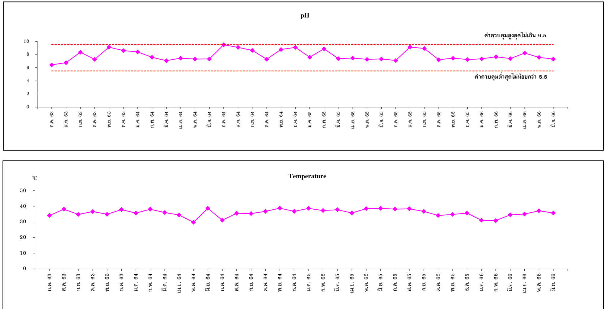
รูปที่ 3.2.2.1-2 กราฟเปรียบเทียบผลการตรวจวิเคราะห์คุณภาพน้ำบริเวณจุดปล่อยน้ำเสียออก (Outlet) ของ CPI Unit ก่อนเข้าสู่ระบบบำบัดน้ำเสียส่วนกลาง ระหว่างปี พ.ศ. 2563-2566
